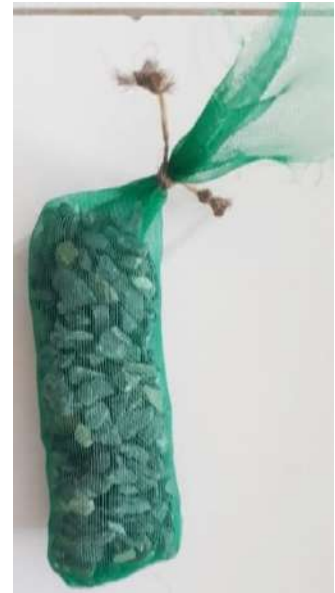
Figura 07: pedra brita envolta com tela de polietileno
